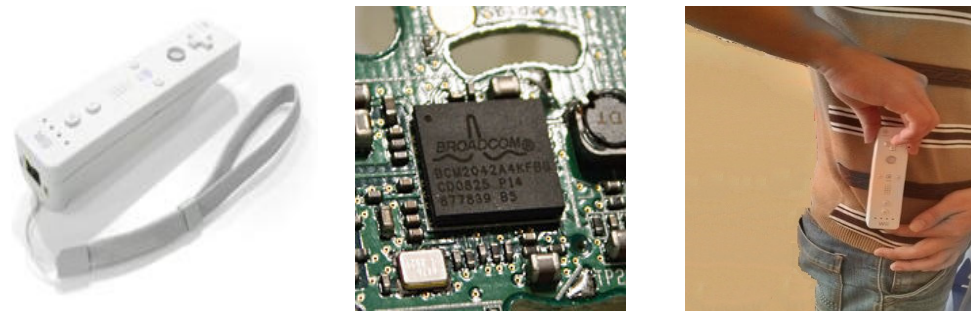
Hình 4.1. Wii Remote (bên trái nhất), bo mạch Broadcom BCM2042 và vị trí đeo Wii Remote
