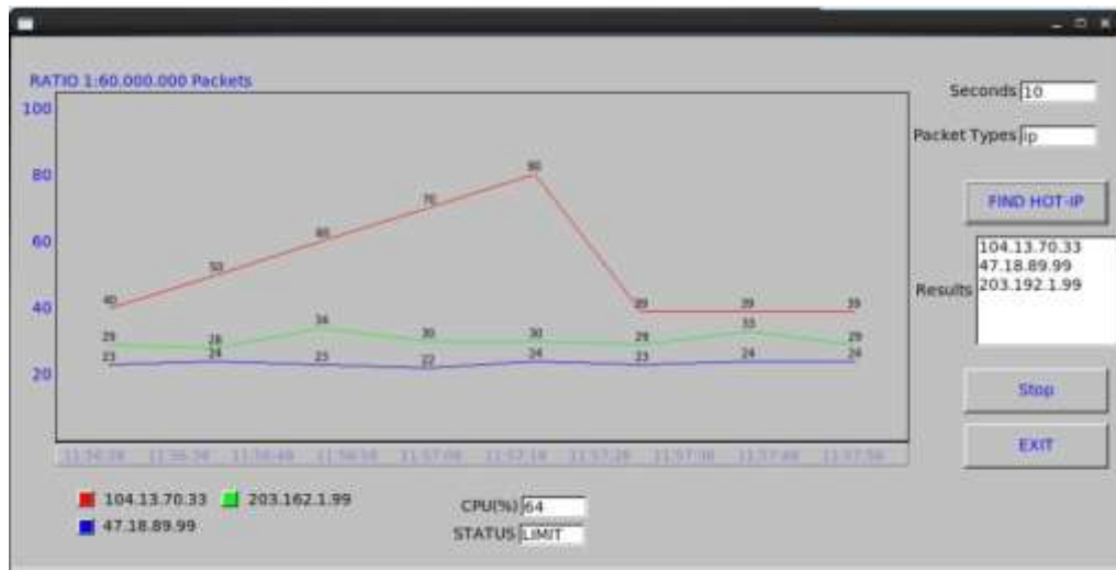
Hình 4.15. Tàn suất của Hot-IP được giới hạn khi CPU trong khoảng 60%-80%
