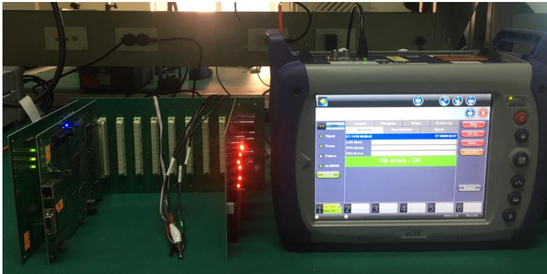
Hình 3.13: Kết nối hệ thống với máy đo lường VeEX UX400
