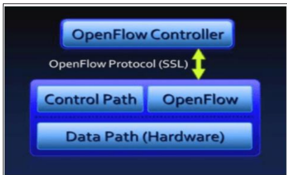
Hình 1.6. Ví dụ về hoạt động của OpenFlow Switch
