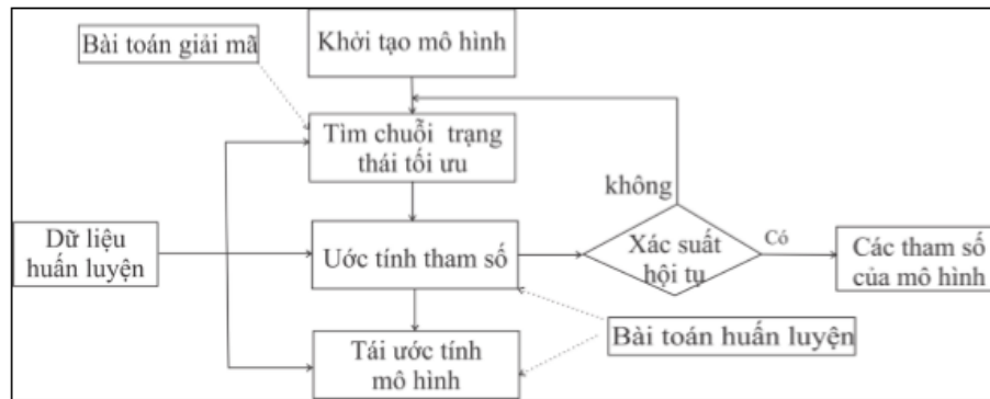
Hình 2-12: Các bước huấn luyện bằng HMM
