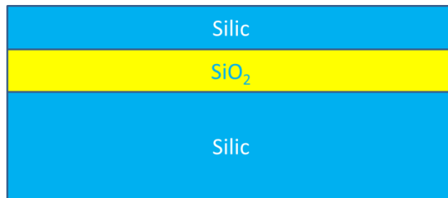
Hình 1.7. Minh họa mặt cắt của một bán dẫn SOI.
