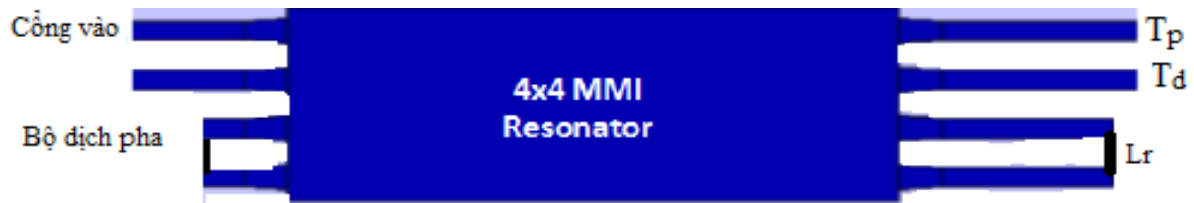
Hình 3.2: Cấu trúc vi cộng hưởng dùng MMI
