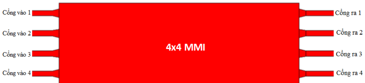
Hình 2.23: Biến đổi DCT và DST dùng 4 \times 4 MMI
