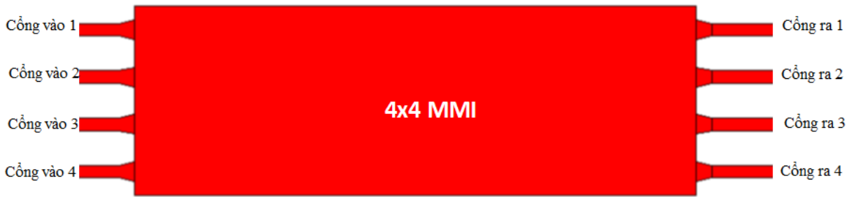
Hình 2.17: Biến đổi DCT và DST dùng 4 \times 4 MMI
