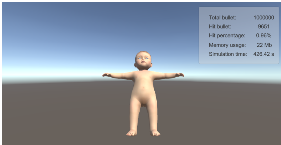
Hình 2.35: Kết quả kiểm thử va chạm với mô hình cơ thể bệnh nhân ảo với hệ hộp bao k-DOPs
