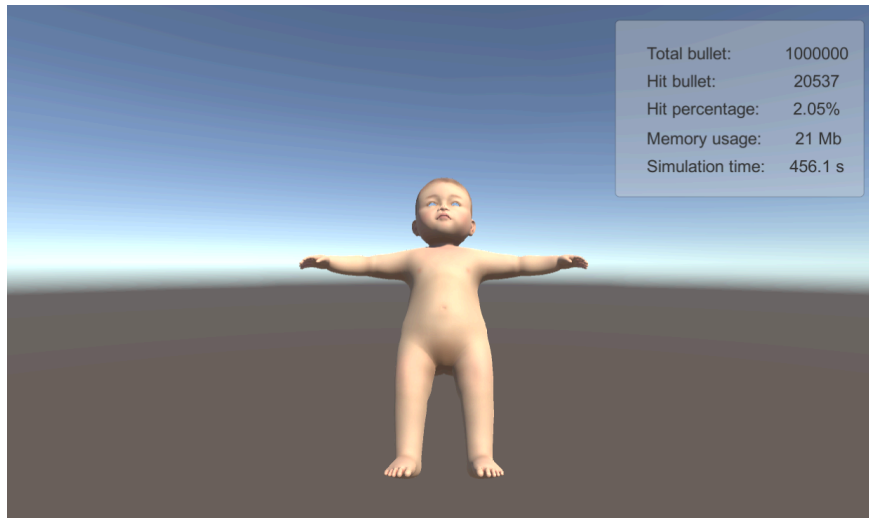
Hình 2.34: Kết quả kiểm thử va chạm với mô hình cơ thể bệnh nhân ảo với Song hệ hộp bao AABB, Convex
