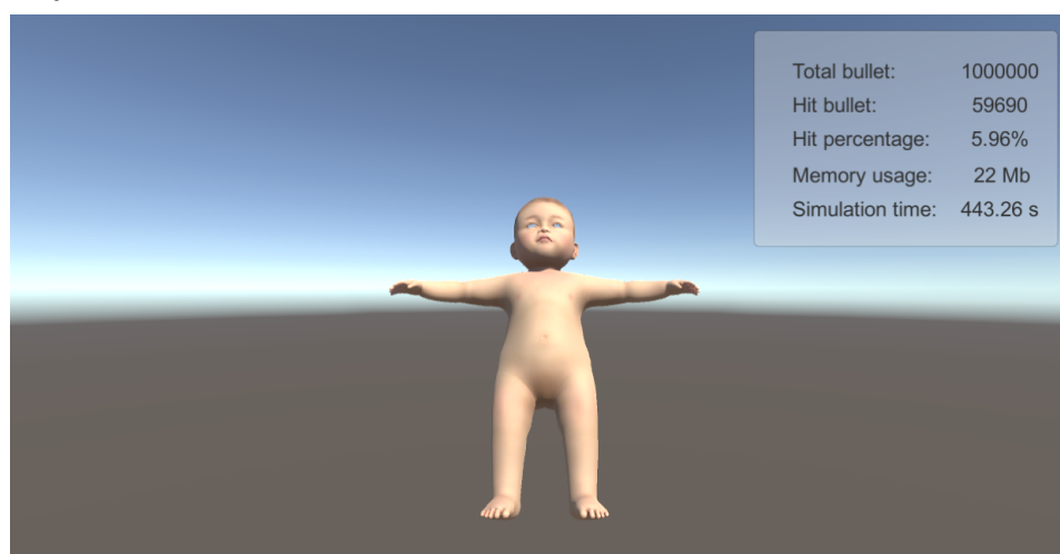
Hình 2.33: Kết quả kiểm thử va chạm với mô hình cơ thể bệnh nhân ảo với hệ hộp bao AABB
